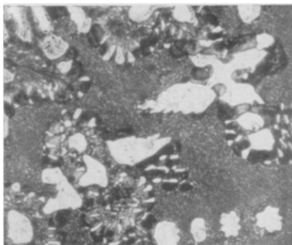
Abb. 1. Gefüge einer Legierung mit 48,9% Cu, 11,0% Ge, 40,1% Ag. Primär: Ag-Mk. (hell); Sekundär: binäres Eutektikum Ag-Mk. (hell) + Cu_5Ge (dunkel). 300fach.
